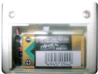
2. 次に、子機のフタを外して電池を取り付けます。
