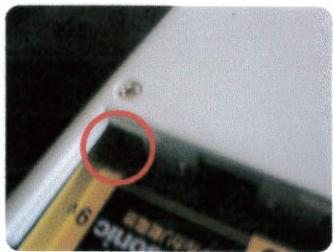
3. 電池とスナップの結合後、電池上部にある電源スイッチを入れます。電源が入りますとパイロットランプが数秒点灯しますので、左図〇の囲み部分に「赤いランプ」が点灯した事を、目視でご確認下さい。数秒後ランプが消えますので、確認後フタを閉じます。
